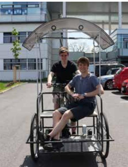
In intensiver Arbeit hat Lukas Jesenko zusammen mit seinem Projektpartner Maximilian Standhartinger ein Fahrrad zu einem vollwertigen Lastenfahrrad mit E-Antrieb umgebaut. Dabei wurde sehr darauf geachtet, dass dieser Umbau mit einfachem Werkzeug und ohne großem Maschinenaufwand möglich ist. Zusätzlich war es den beiden Mechatrikern ein großes Anliegen, das Projekt zu einem leistbaren Preis abzuwickeln. Konkret haben sie den Rahmen des Lastenfahrrades entsprechend
